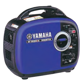
ヤマハ EF1600iS サイズ: 490×280×445mm 定格出力: 1.6KVA 燃料タンク容量: 4.2ℓ 重量: 20kg
