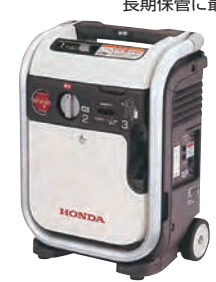
カセットガス発電機「エ・ネ・ボ」 EU9iGB サイズ: 365×262×524mm 定格出力: 0.9KVA 使用燃料: LPG (液化ブタン/指定カセットボンベ) 重量: 19.5kg
