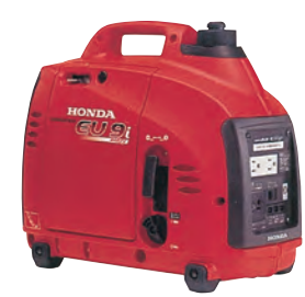
ホンダ EU9i entry サイズ: 450×240×380mm 定格出力: 0.9KVA 燃料タンク容量: 2.3ℓ 重量: 13kg
